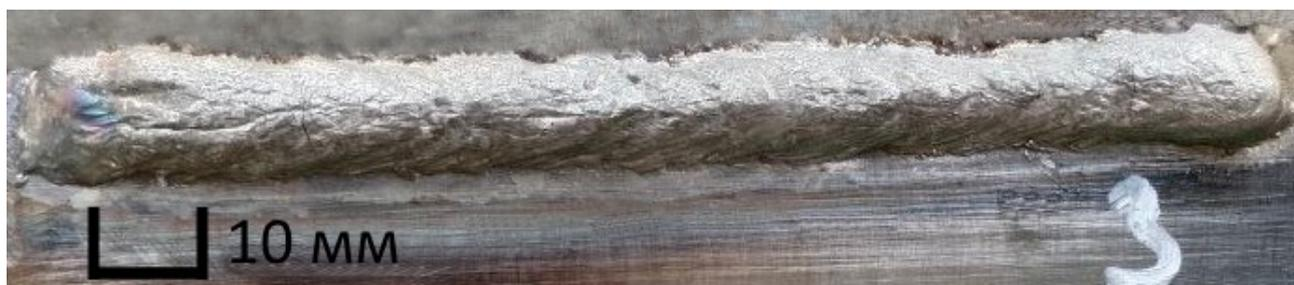
**Рис. 16.** Внешний вид наплавленного валика, полученного двухдуговой наплавкой при следующем режиме:
