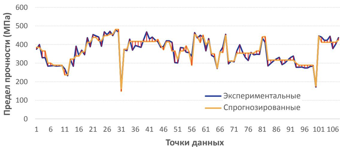
Рис. 9. Экспериментальные и спрогнозированные значения предела прочности (ИНС)
