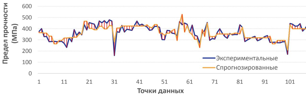
**Рис. 11.** Экспериментальные и спрогнозированные значения предела прочности (полиномиальная регрессия)
