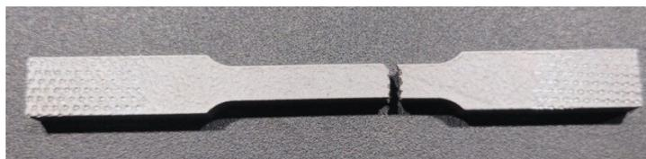
Рис. 4. Разрушенный образец
