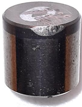
**Рис. 7.** Вид изношенной поверхности поликристаллической алмазной пластины
