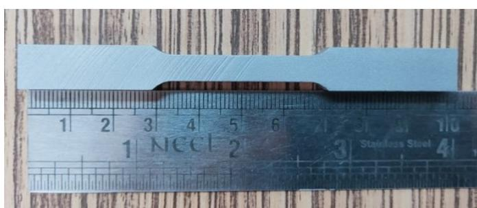
Рис. 2. Параметры образца: *a* – размеры; *b* – образец
