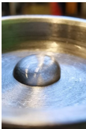
Рис. 7. Капля воды на несмачиваемой поверхности Fig. 7. A drop of water on a non-wetted surface
