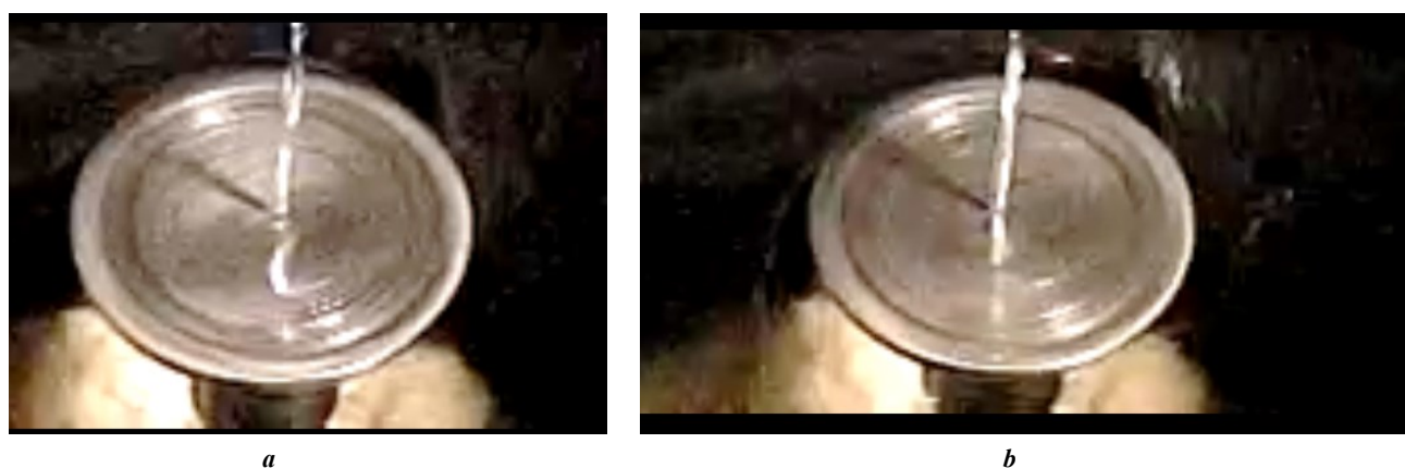
Рис. 5. Изменение давления при подаче жидкости на поверхность чаши без обработки, диаметр иглы 1,5 мм: a – 1 атм.; b – 2 атм. Fig. 5. Changing pressure when liquid is supplied to the surface of the bowl without treatment, needle diameter is 1.5 mm: a – 1 atm.; b – 2 atm.
