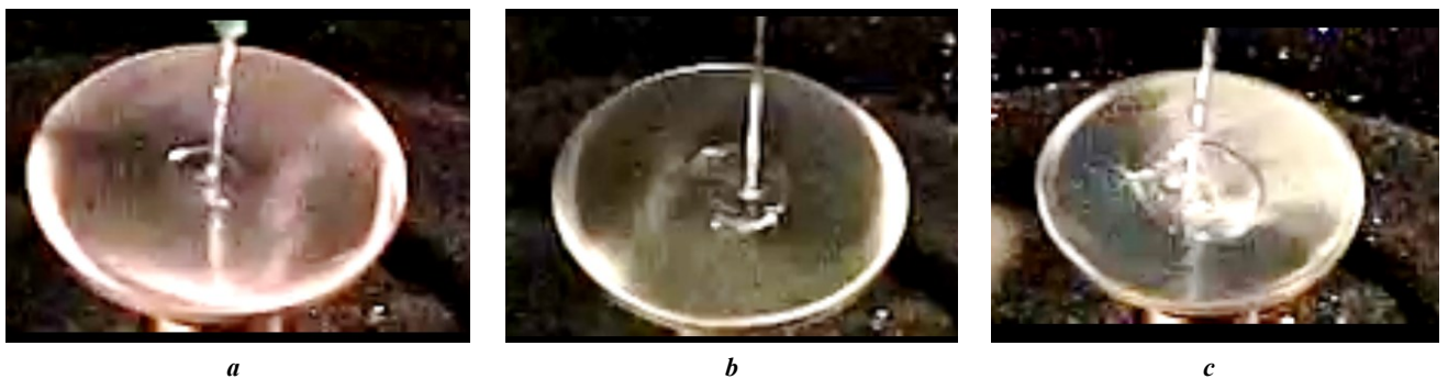
Рис. 2. Изменение высоты подачи жидкости от чаши при потоке 6,69 кг/ч и гладкой обработке чаши: а – 20 мм; б – 50 мм; с – 150 мм Fig. 2. Changing the height of liquid feed from the bowl at a flow rate of 6.69 kg/h and smooth bowl processing: а – 20 mm; б – 50 mm; с – 150 mm
