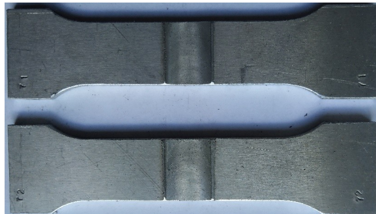
Fig. 3. Specimens for static tensile tests Рис. 3. Образцы для проведения испытаний на статическое растяжение
