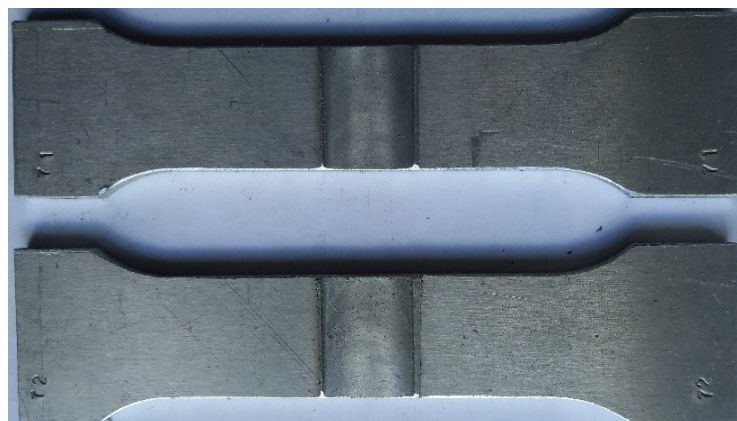
Рис. 3. Образцы для проведения испытаний на статическое растяжение Fig. 3. Specimens for static tensile tests
