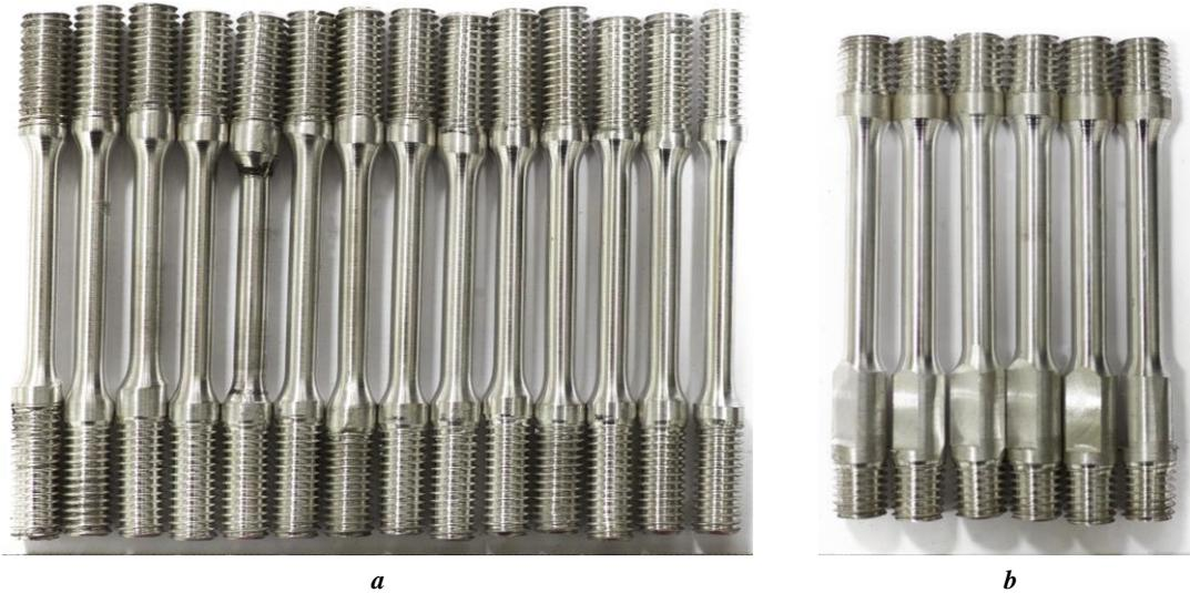
Рис. 1. Образцы для механических испытаний: *a* – для массовых температурно-скоростных испытаний; *b* – с лыской для испытаний с одновременной регистрацией сигнала акустической эмиссии
