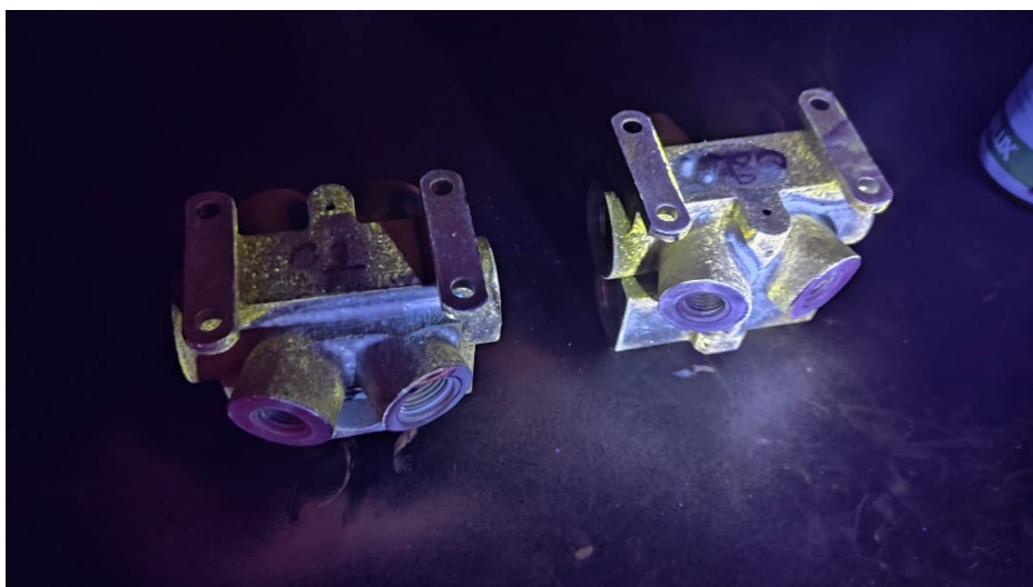
Fig. 6. Result Dye penetrant test of selector valve body parts Рис. 6. Результат цветной дефектоскопии деталей корпуса переключателя
