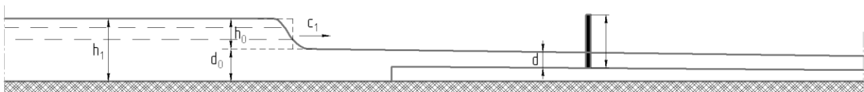
Рис. 7. Схема процесса подхода исходной прерывной волны на участок с уступом и местным сужением
