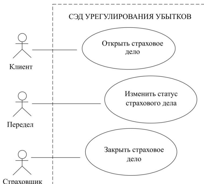
Рис. 3. Диаграмма вариантов использования СЭД урегулирования убытков
