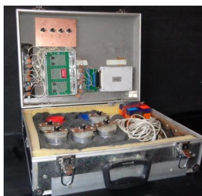
Рис. 1. Программно-аппаратная часть кейса имеет в своем составе: АЦП (справа), стабилизационную плату (слева), основа с гнездами для подключения датчиков (вверху). В нижней части кейса размещены пьезодатчики и соединительные провода
