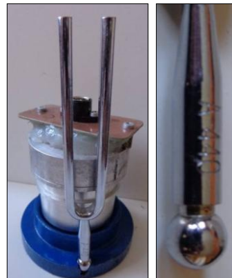
Рис. 2. Камертон вмонтирован в подставку для датчика, регистрирующего воспроизводимые им колебания. Справа - отметка сертификата на одной из ветвей камертона
