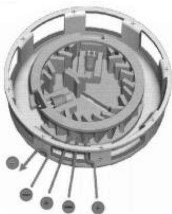
Рис. 3. Принцип взаимодействия заряженных частиц дыма и корпуса дымового извещателя с обычными дымозаходными отверстиями
