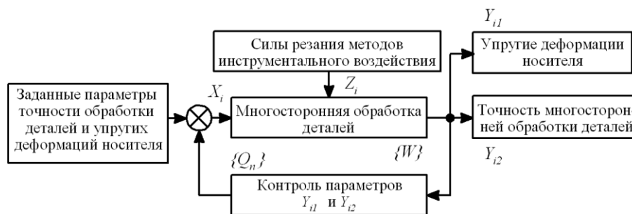
Рис. 7. Структурная схема управления процессом силового нагружения и обеспечения точности обработки
