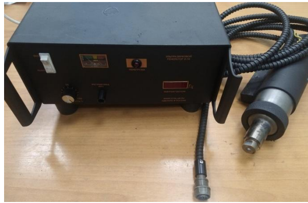
Рис. 1. Ультразвуковая установка для упрочняюще-чистовой обработки деталей И-4/1-2.0 Fig. 1. I-4/1-2.0 ultrasonic device for hardening and finishing of parts
