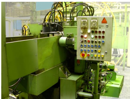
Рис. 1. Внешний вид станка для обработки ППД без использования СОТС вала первичного коробки передач автомобиля LADA
