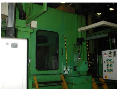
Рис. 2. Внешний вид станка для высокопроизводительной обработки широким выглаживанием вала коленчатого двигателя автомобиля LADA
