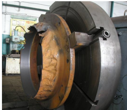
Рис. 3. Установочное кольцо грунтового насоса землесосного снаряда после намыва 150 тыс. т песка
