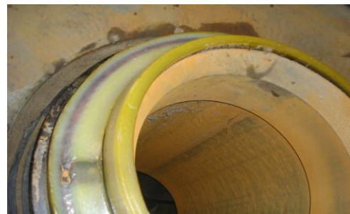
Рис. 2. Изношенное уплотнительное кольцо грунтового насоса после эксплуатации
