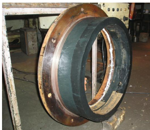
Рис. 4. Установочное кольцо после намыва более 1 млн т песка и повторно восстановленное
