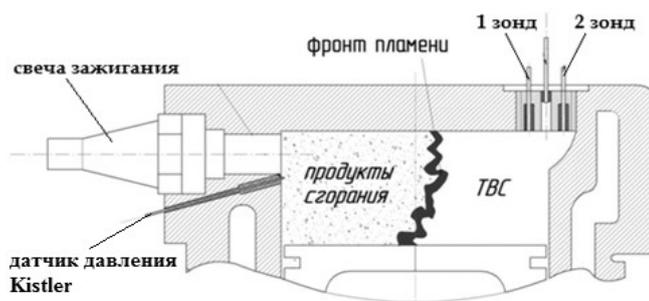
Рис. 1. Камера сгорания УИТ-85 с установленными датчиками
