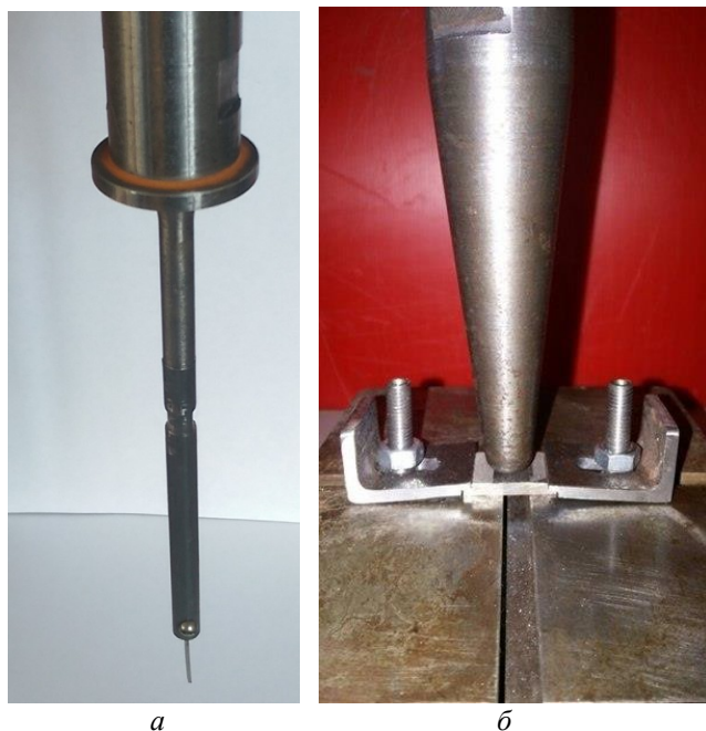
Рис. 1. Обработка аморфных лент: а) в разрезном волноводе продольных ультразвуковых колебаний; б) в ультразвуковой наковальне
