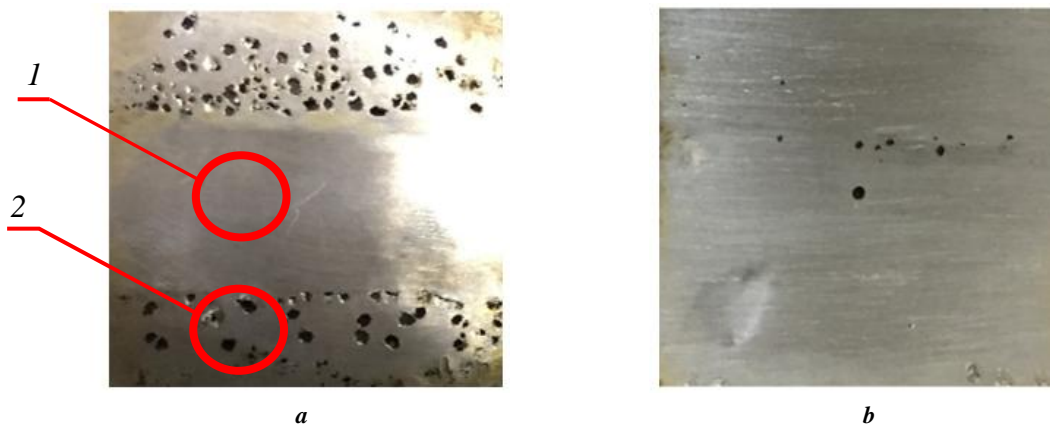
Рис. 6. Поверхность стыковых сварных швов СММ с ВП после коррозионных испытаний в растворе хлорида железа (III) в течение 216 ч (×30): a – без облицовочного слоя; b – с облицовочным слоем; 1 – сварной шов; 2 – околошовная зона Fig. 6. The surface of butt weld joints of LMM with IP after corrosion tests in the ferrous III chloride solution during 216 h (×30): a – without capping pass; b – with capping pass; 1 – welding seam; 2 – weld-adjacent zone
