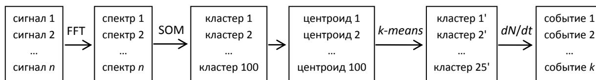
Рис. 1. Схема обработки зарегистрированных сигналов АЭ
