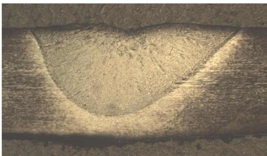
*Рис. 4. Макрошлиф точки № 3,  $\times 20$*
