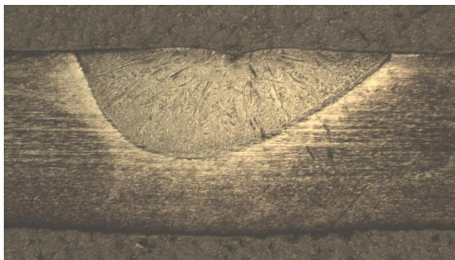
*Рис. 3. Макрошлиф точки № 2,  $\times 20$*
