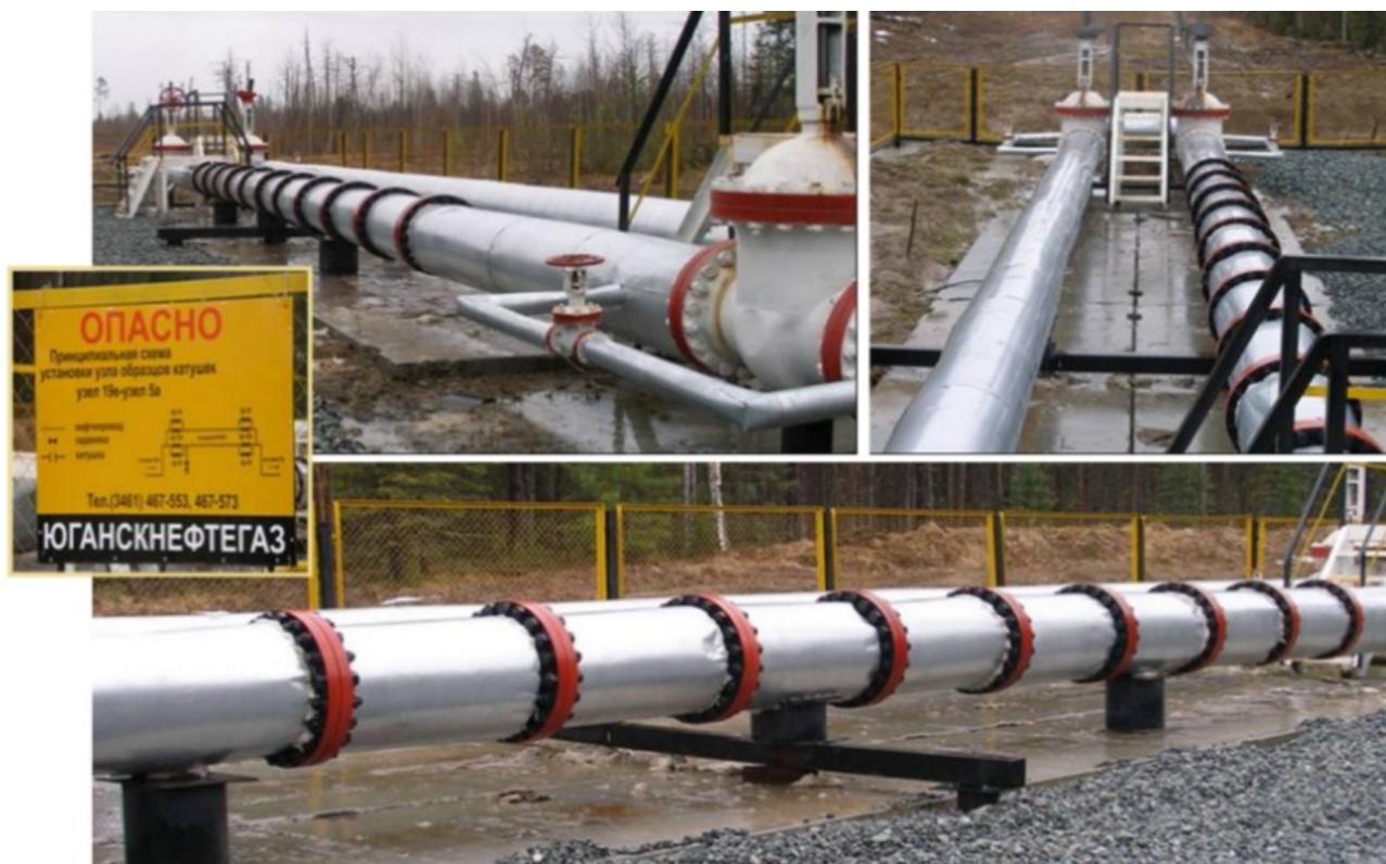
Рис. 2. Байпасные испытания образцов труб (катушек) в составе напорного нефтепровода организации ООО «РН-Юганскнефтегаз»
