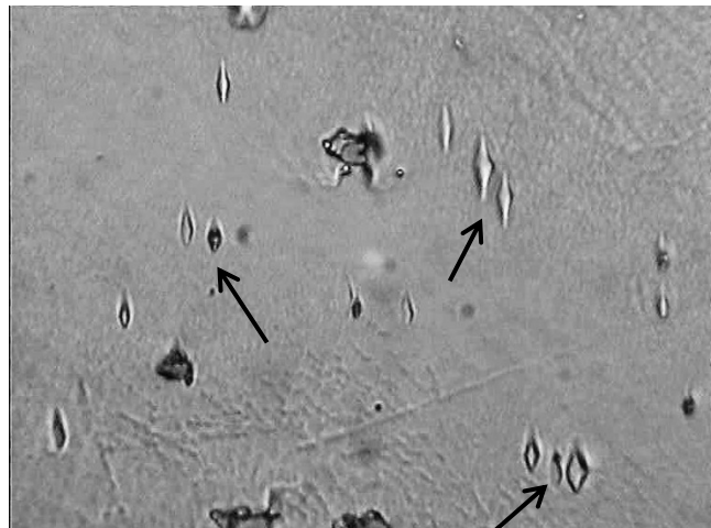
Рис. 4. Когерентные выделения (указаны стрелками), партия № 1', увеличение: а – \times 500 ; б – \times 1000
