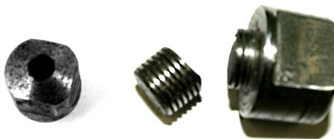
Рис. 3. Характер поврежденности инструмента при ультразвуковом выглаживании
