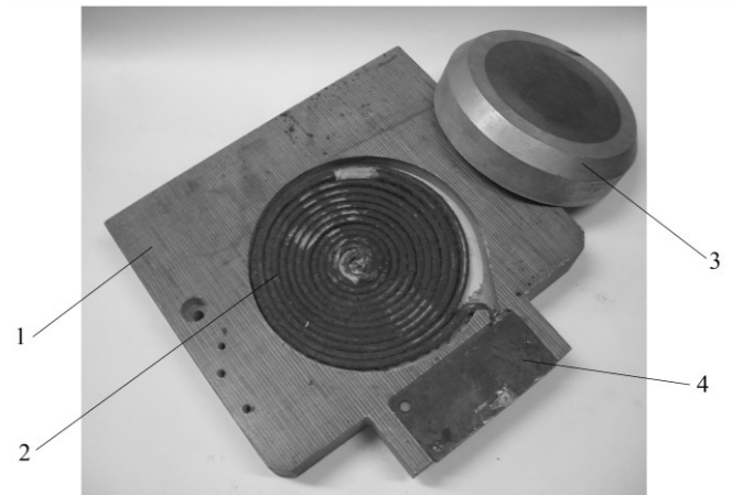
Рис. 2. Индукционно-динамический привод: 1 – бандаж; 2 – спираль Архимеда; 3 – толкатель; 4 – токоподводы
