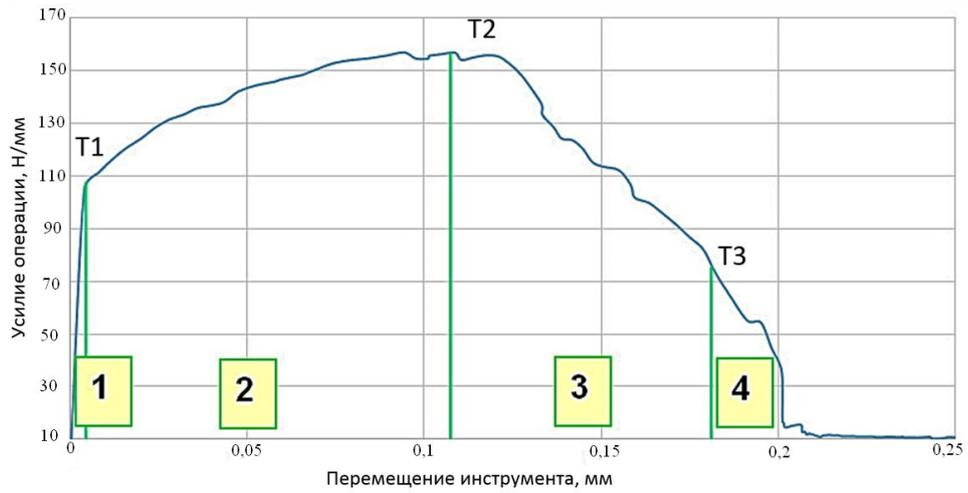
Рис. 3. Анализ напряженно-деформированного состояния материала в зоне реза для четырех стадий процесса
