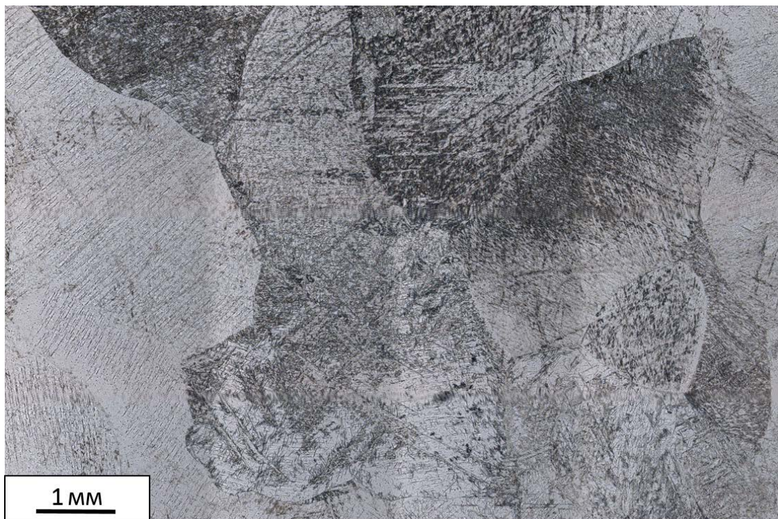
Рис. 2. Микроструктура чистого магния (оптическая микроскопия) Fig. 2. Microstructure of pure magnesium (optical microscopy)
