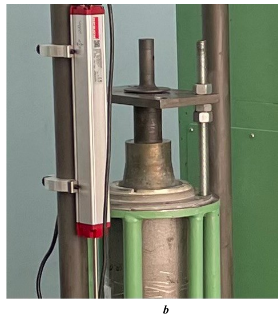
Fig. 1. Schematic (a) and external appearance (b) of the acoustic unit of the ultrasonic assisted ECAP device Рис. 1. Схема (a) и внешний вид (b) акустического узла устройства ультразвукового РКУП
