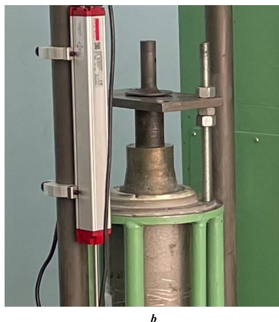
Рис. 1. Схема (а) и внешний вид (б) акустического узла устройства ультразвукового РКУП Fig. 1. Schematic (a) and external appearance (b) of the acoustic unit of the ultrasonic assisted ECAP device
