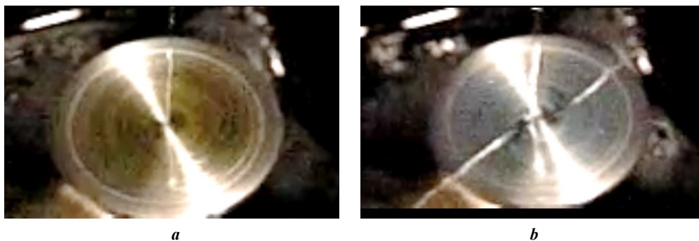
Fig. 8. Changing pressure when supplying to a non-wetted surface of a bowl: a – 1 atm.; b – 4 atm. Рис. 8. Изменение давления при подаче на несмачиваемую поверхность чаши: a – 1 атм.; b – 4 атм.
