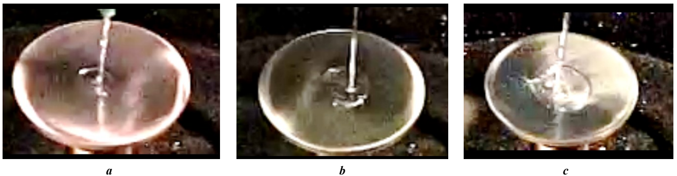
Fig. 2. Changing the height of liquid feed from the bowl at a flow rate of 6.69 \text{kg/h} and smooth bowl processing: a – 20 mm; b – 50 mm; c – 150 mm Рис. 2. Изменение высоты подачи жидкости от чаши при потоке 6,69 \text{кг/ч} и гладкой обработке чаши: a – 20 мм; b – 50 мм; c – 150 мм
