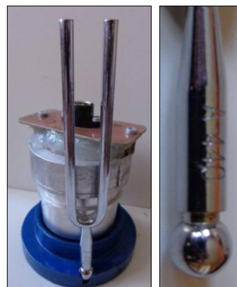
Рис. 2. Камертон вмонтирован в подставку датчика, регистрирующего воспроизводимые им колебания. Справа - отметка сертификата на одной из ветвей камертона
