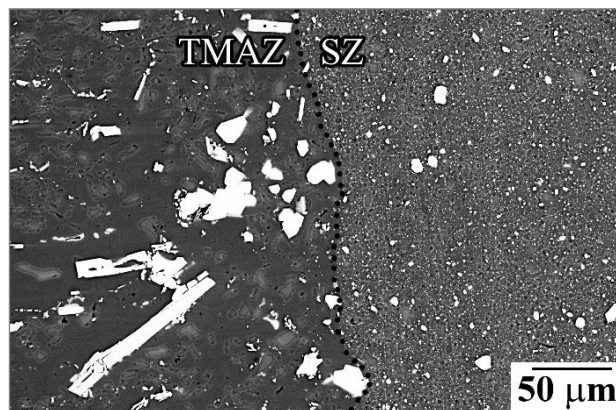
Рис. 3. Типичная микроструктура перехода между зоной TMAZ и зоной SZ в сплаве АК12Д после ОТП при \omega=2000 об/мин и v=16 мм/мин и последующей термообработки.
