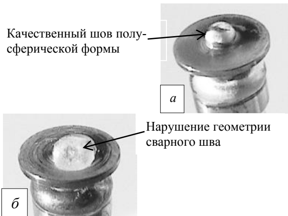
Рис. 5. Внешний вид сварных соединений, выполненных на одних режимах сварки ( I_{св}=30 А; L_0=1 мм) при разном давлении гелия: а – 0,3 МПа; б – 15 МПа
