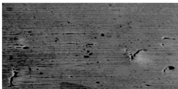
Рис. 4. Поверхность, обработанная по технологии безсожевого поверхностного пластического деформирования
