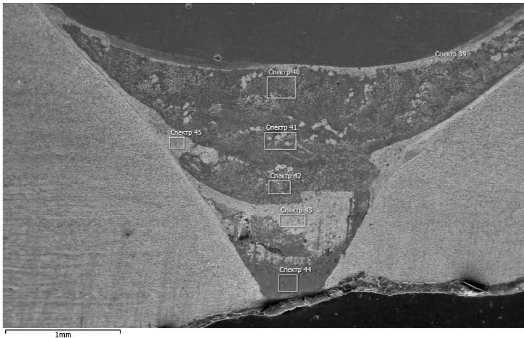
**Рис. 5.** Граница взаимодействия расплавленного металла и эмалевого покрытия при использовании электродной проволоки на основе меди
