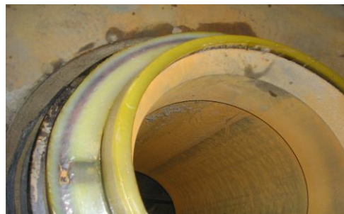
Рис. 2. Изношенное уплотнительное кольцо грунтового насоса после эксплуатации
