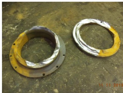
Рис. 1. Изношенное установочное кольцо грунтового насоса землесосного снаряда после эксплуатации
