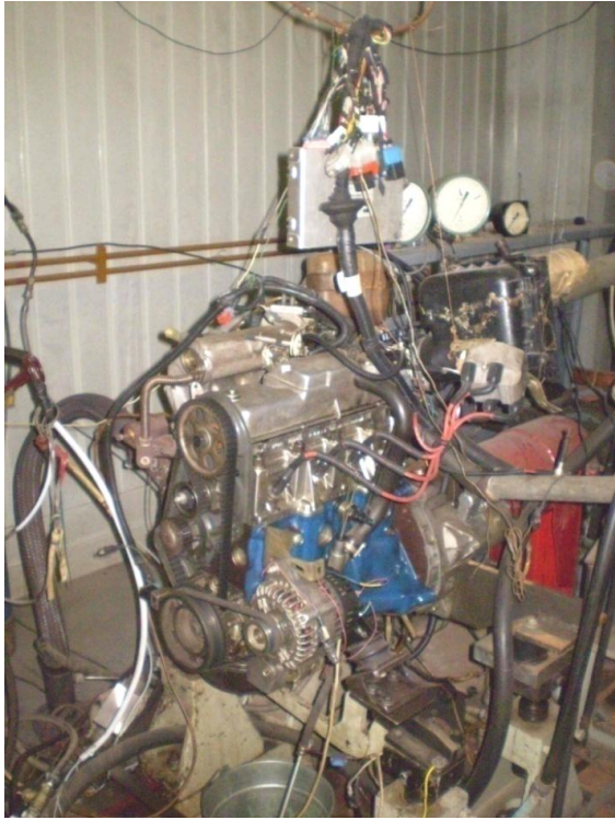
Рис. 1. Двигатель VAZ-2111 с распределенным впрыском топлива
