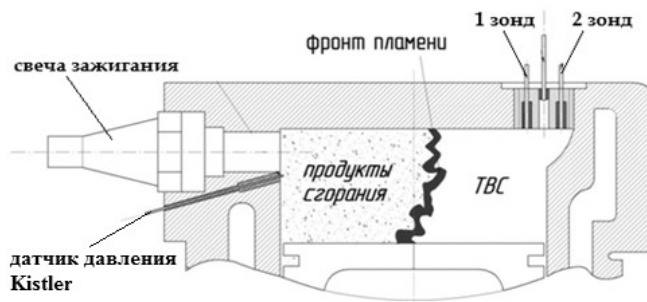
Рис. 1. Камера сгорания УИТ-85 с установленными датчиками
