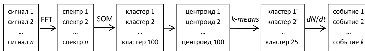
Рис. 1. Схема обработки зарегистрированных сигналов АЭ Fig. 1. Scheme for the recorded AE signals processing
