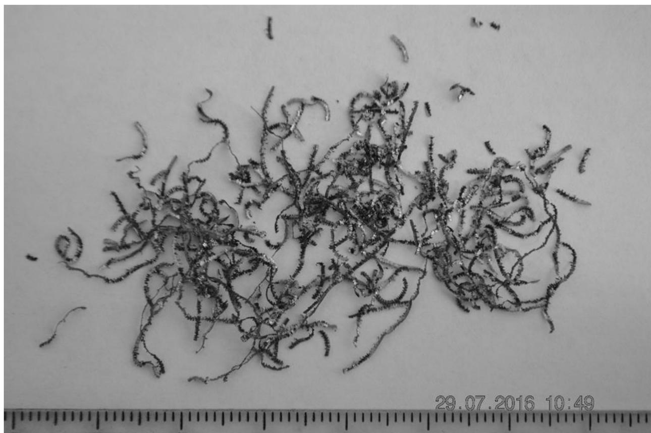
*Рис. 4. Сливная стружка*
