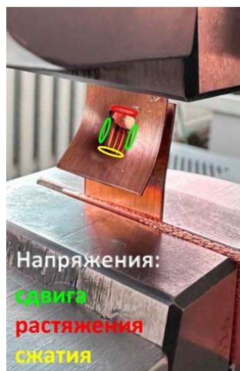
Рис. 6. Сварной образец в клиновых захватах машины во время испытаний на сдвиг растяжением.
