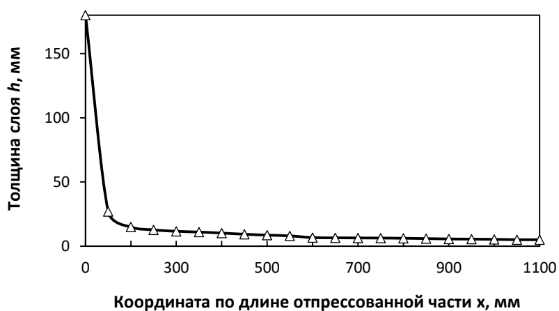
Рис. 5. График зависимости толщины плакирующего слоя h от координаты по длине отпрессованной части изделия x
