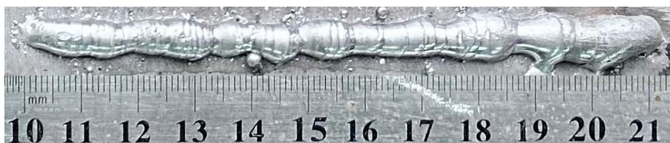
**Рис. 6.** Внешний вид наплавленного валика, полученного при следующем режиме:
