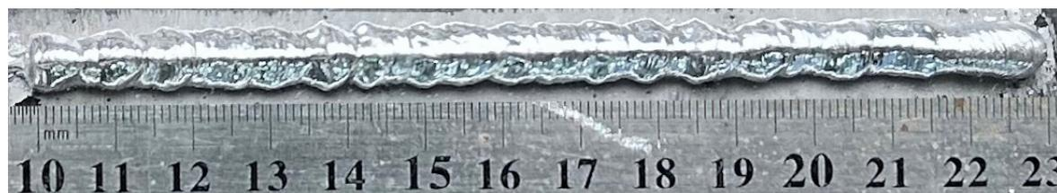
**Рис. 7.** Внешний вид наплавленного валика, полученного при следующем режиме:
