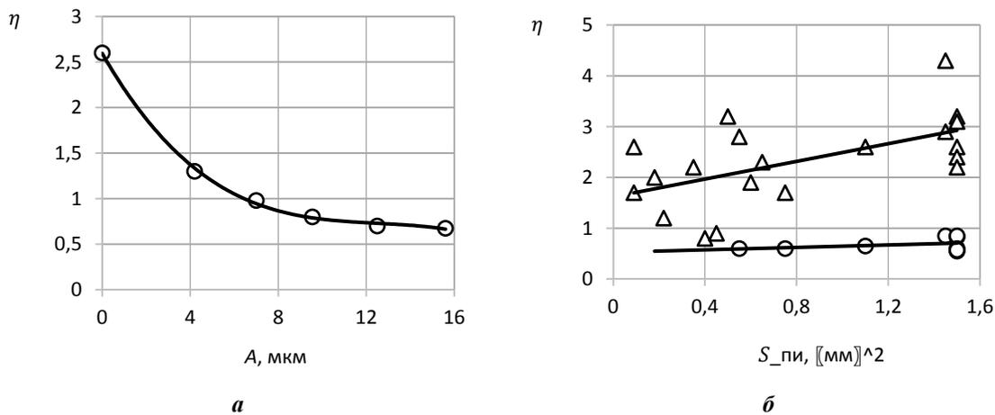
**Рис. 5.** Влияние амплитуды  $A$  колебаний и площади  $S_{пн}$  контактной поверхности ПИ на величину опорной поверхности  $\eta$  круга:
