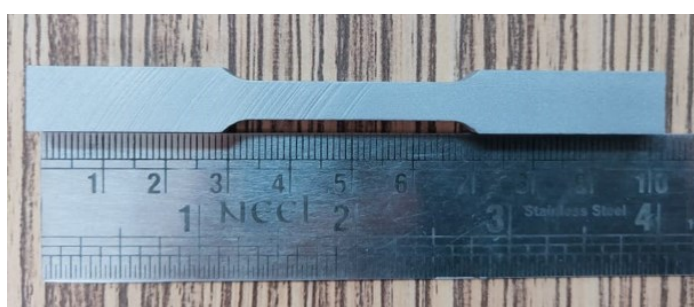
Рис. 2. Параметры образца: a – размеры; b – образец Fig. 2. Sample details: a – sample dimension; b – fabricated sample
