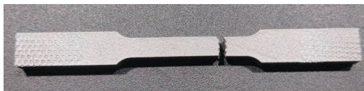
Рис. 4. Разрушенный образец Fig. 4. Fractured sample
