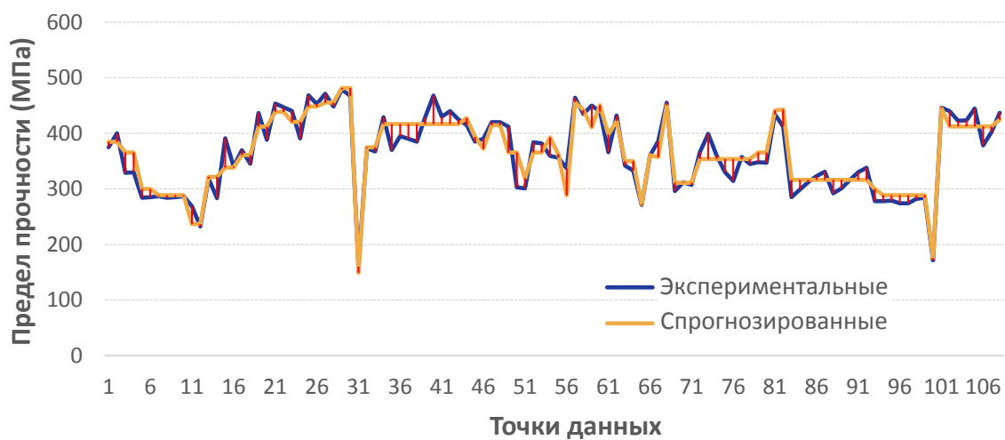
Рис. 9. Экспериментальные и спрогнозированные значения предела прочности (ИНС) Fig. 9. Experimental vs predicted values of tensile strength (ANN)
