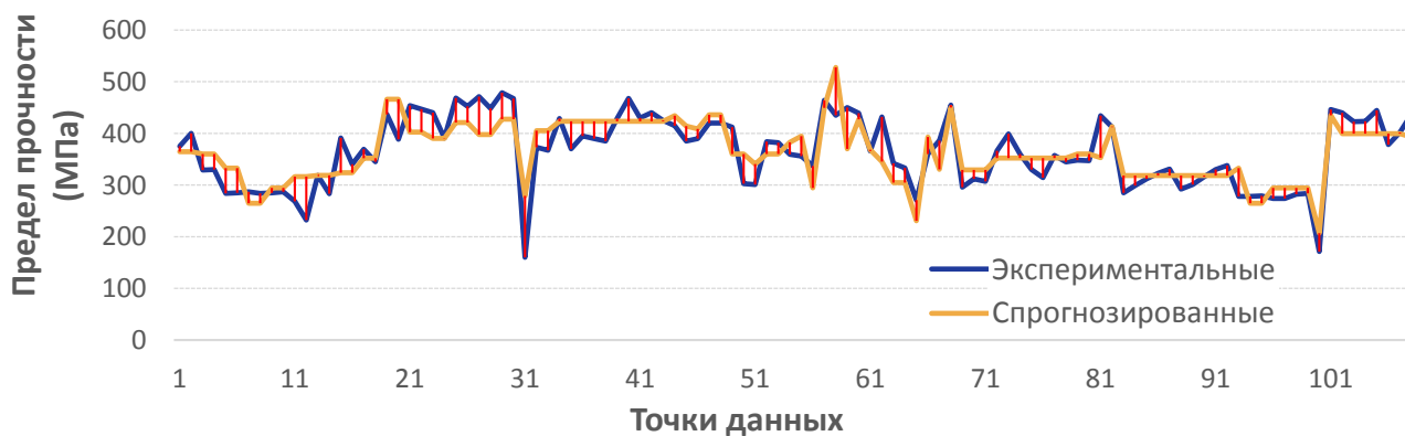
Рис. 11. Экспериментальные и спрогнозированные значения предела прочности (полиномиальная регрессия) Fig. 11. Experimental vs predicted values of tensile strength (polynomial regression)
