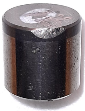
Рис. 7. Вид изношенной поверхности поликристаллической алмазной пластины Fig. 7. View of the worn surface of a polycrystalline diamond insert
