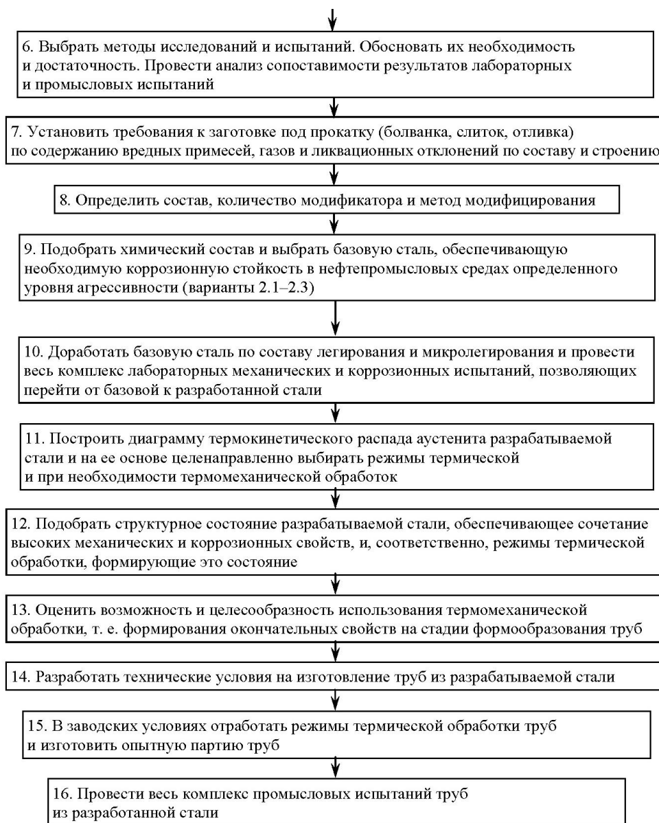
Рис. 1. Часть 2 Последовательность мероприятий (алгоритм) разработки и создания сталей для производства нефтепромысловых труб
